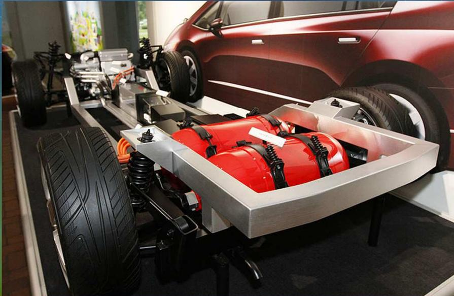
Véhicule alimenté en hydrogène, pour produire l'énergie électrique nécessaire à son moteur, grâce à une pile à combustible. Chacun des réservoirs stocke quelques kg d'hydrogène gazeux à 350 bars.
