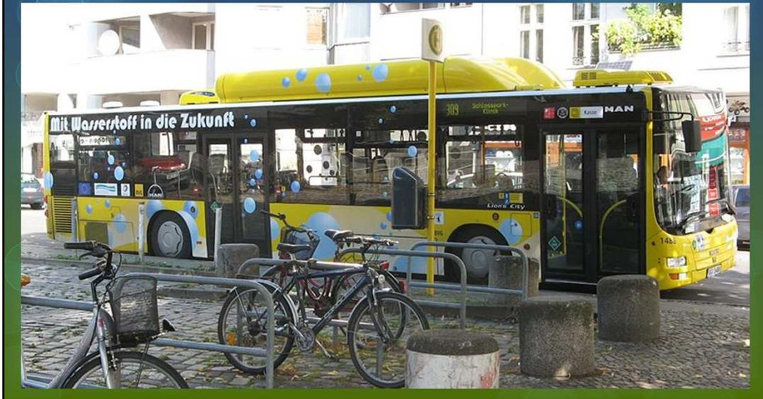
Bus avec un moteur à combustion interne fonctionnant à l'hydrogène circulant sur la ligne 309 de la ville de Berlin. Le bus est muni de dix réservoirs chacun stockant 50 kg d'hydrogène gazeux à 350 bar. Le bus pèse environ 18 tonnes et peut transporter 80 personnes sur environ 220 km. On peut lire « Mit Wasserstoff in die Zukunft », i.e. « avec de l'hydrogène dans le moteur ».
