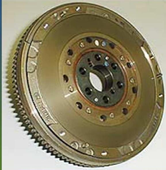
Volant d'inertie d'un moteur de véhicule de tourisme. On distingue les dents de la couronne en périphérie. L'embrayage est du côté non visible.
